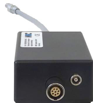
Abbildung 4: Kabelbox mit Signalverarbeitung außerhalb des Vakuums
