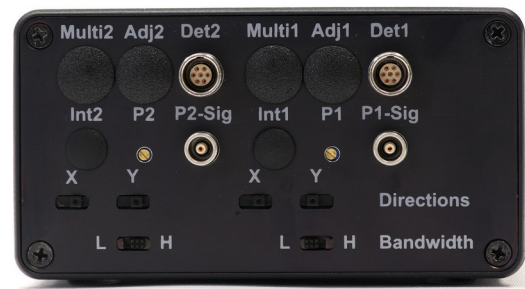
Abbildung 7: Eingangsbuchsen, P-Faktor-Einstellungen und Schalter an der rechten Gehäusesseite
