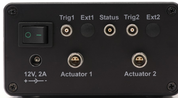
Abbildung 16: Linke Seite der Steuerungselektronik mit Trigger-Eingängen
