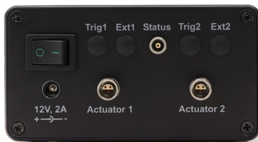
Abbildung 6: Spannungseingang und Ausgangsbuchsen an der linken Gehäusesseite
