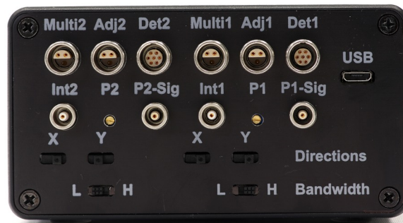
Abbildung 24: Rechte Seitenplatte mit zusätzlichen „Adjust-in“-Eingängen zur Verstellung der x und y Sollposition auf zwei PSDs
