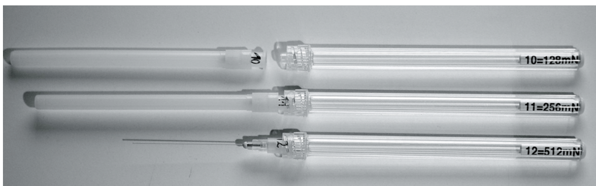
Abbildung 1: Teile eines OptiStim-Stimulators: Schutzkappe, Glasfaser und Griff.
